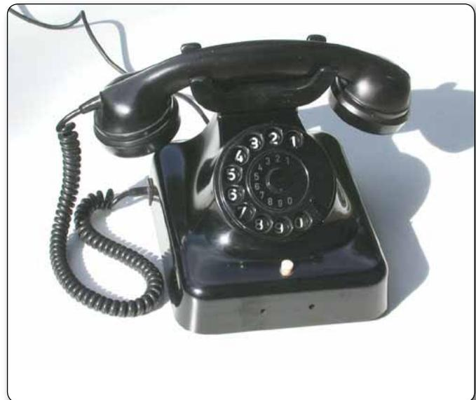
Der Tischfernsprecher W 48 war – nach dem vom Hersteller SABA nur kurz produzierten Tischfernsprecher W 46 – das zweite deutsche Nachkriegstelefon, das 1948 für die Deutsche Post in den westlichen Besatzungszonen entwickelt und in sehr großen Stückzahlen gefertigt wurde.
